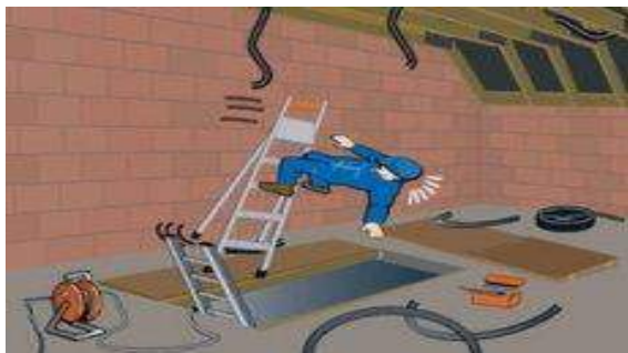
Illustration des risques de chute de hauteur
