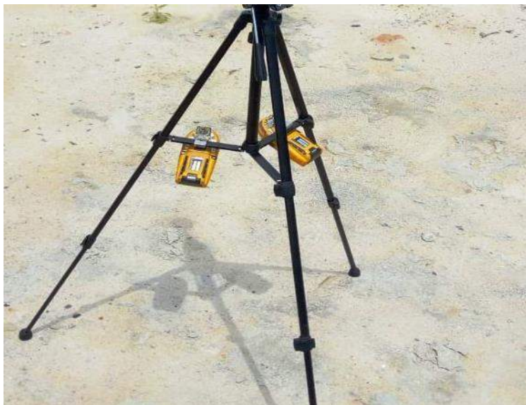
Photo 2 : Mesures des gaz de combustion dans l'air ambiant à l'aide des détecteurs GASALERT
