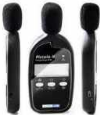
Figure 5-1 : Vue du sonomètre Piccolo II
